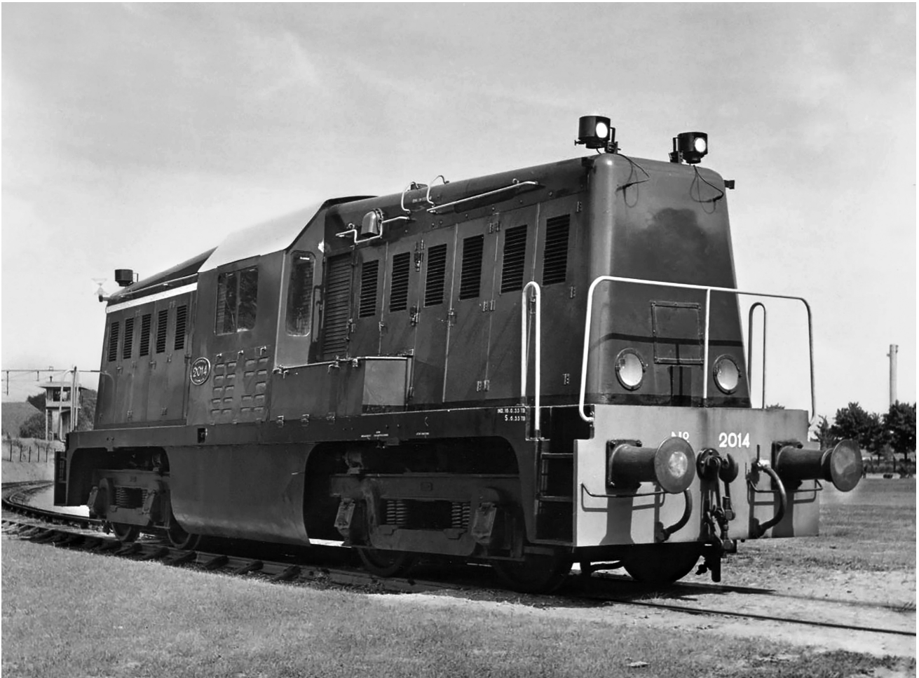
NS 2014 kort na inbouw van de nieuwe motoren. Op de voetplaat is de extra accukist zichtbaar, daarboven tegen de huif de extra luchtinlaat en helemaal bovenop nog net de nieuwe schoorsteen. (Foto: W.K. Steffen)
