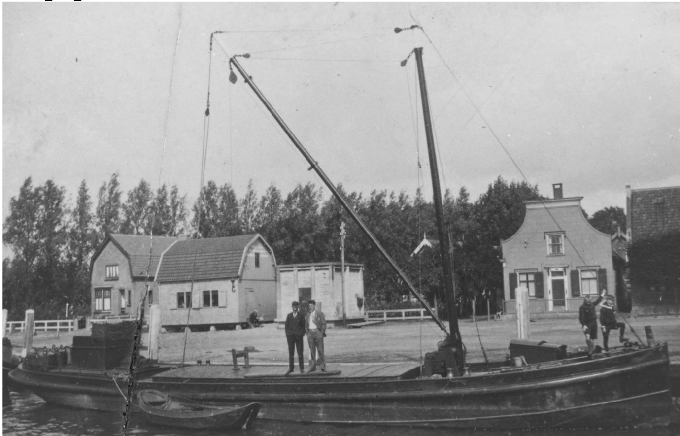
Rond 1935 was het afgebeelde schip van Verloop te Alblasterdam voorzien van een eenvoudig plaatijzeren scherm zoals vele tot in de jaren '60 zouden behouden. Beeldbank Dordrecht inv. nr. 1241_5122
