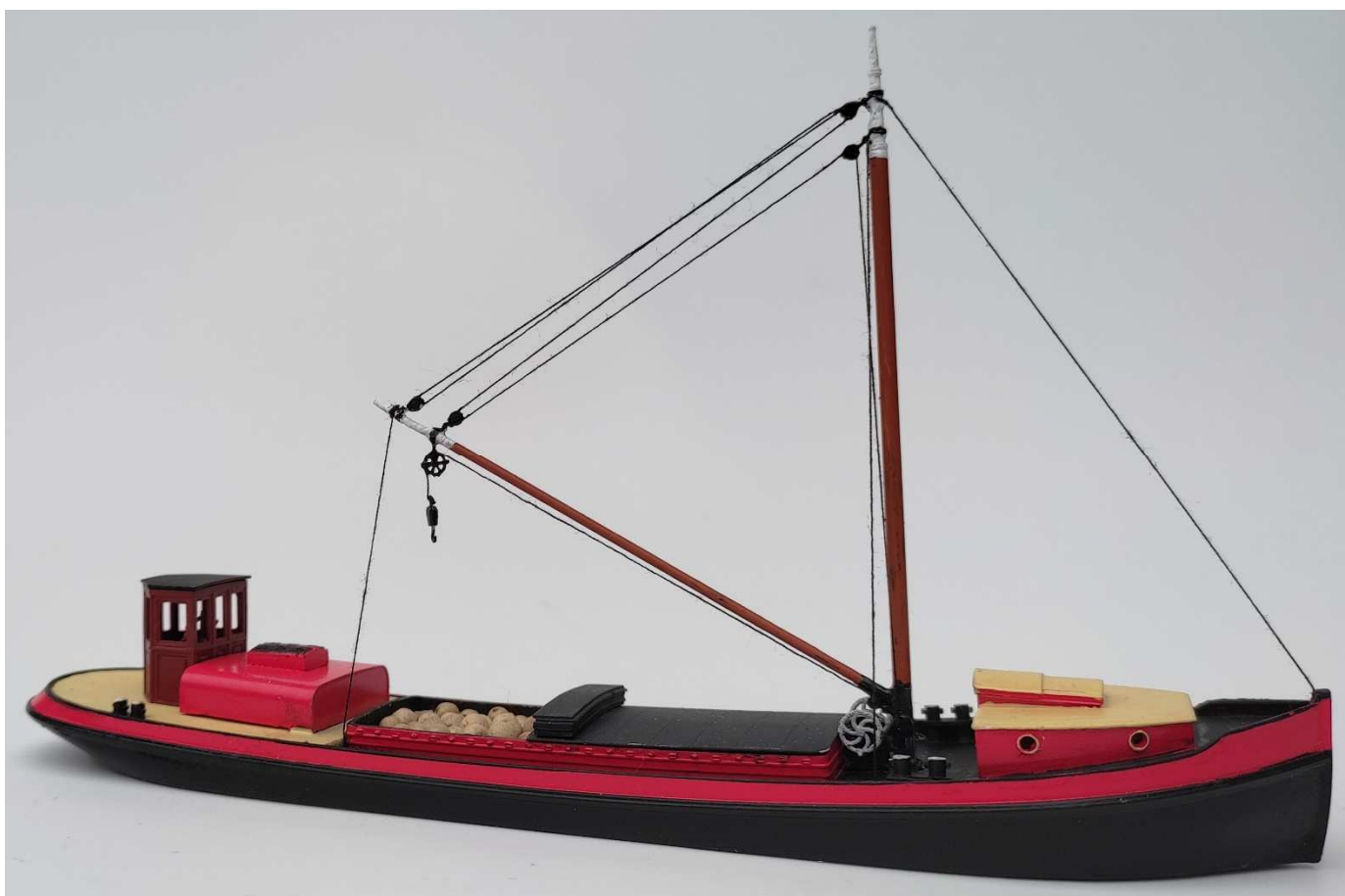
Model opgebouwd met laadgerei, woonruimte voorop en een machinekamer voor de stuurhut.
