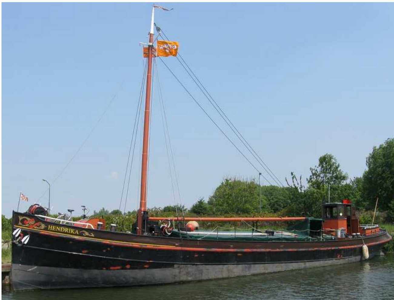
Schip "Hendrika" was bij bouw in 1913 20,5m lang en is in 1953 nog met 4m verlengd. Het is tot 1968 als beurtschip gebruikt en vaart nog steeds, ruim 110 jaar oud.
