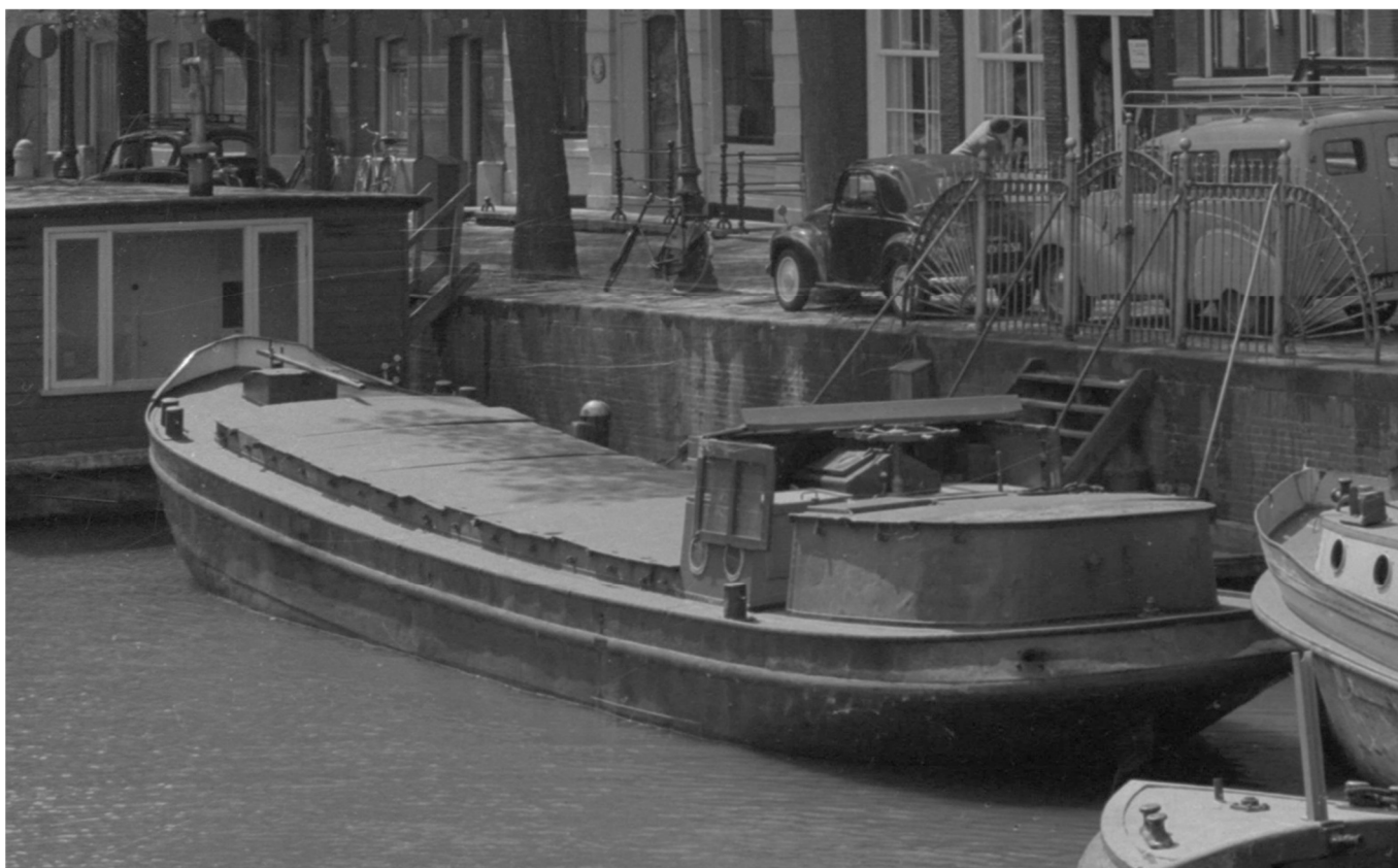
Afgebeeld schip ligt in 1957 vrijwel ongewijzigd aan de kade. Er is een demontabele stuurhut gemaakt die hier is neergeklapt. Het raam aan de zijkant zit met scharnieren bovenaan vast. Het dak zal een eenvoudig stuk zeil zijn geweest. Deze schepen konden zo ook onder de verschillende lage bruggen in o.a. Amsterdam varen.
